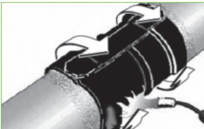
**Gelbe Materialien sind mit einem Temperaturindikator ausgestattet.** Durch einen Farbumschlag in ein dunkles Orange wird dem Monteur signalisiert, dass nun **die optimale Temperatur erreicht** ist.
