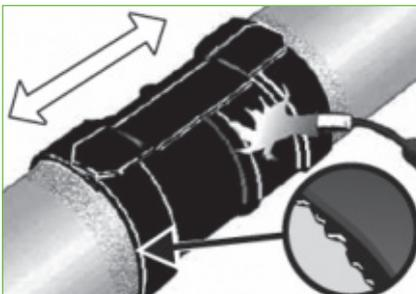
Sofort nach dem Schrumpfprozess kann durch **Fingerdruckprobe** geprüft werden, ob der Schmelzkleber überall gleichmäßig erwärmt und aufgeschmolzen wurde.
