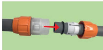
Das Rohr zuerst in das Gehäuse des Fitting schieben bis es am mittigen Anschlagring anliegt. Anschließend den O-Ring und den Grip-Ring einschieben.
