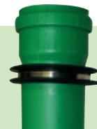
**Bodendurchführungen** dienen als zuverlässige, druckdichte Rohrdurchführung, wenn die Leitung direkt im WU-Beton der Bodenplatte vergossen wird. Der Lieferumfang inkl. Wassersperre und Verschlusskappen ermöglicht eine unkomplizierte und schnelle Handhabung.
