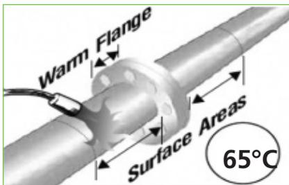
Nun wird die Manschette **mittig** über die Verbindung gelegt, beim herumlegen wird die **Schutzfolie entfernt**.
