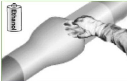
Die geteilte Schrumpfmanschette mit Überlappung **von der Rolle ablängen** und einen passenden Verschlussstreifen dazu bereitlegen, ca. 120 mm.
