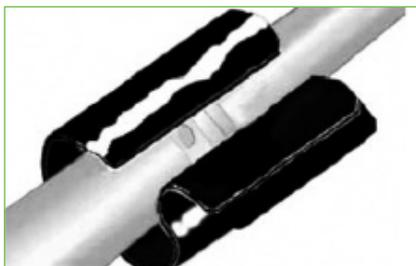
Die Schrumpfmanschette wird nun **von der Mitte nach außen ringförmig erwärmt**.
