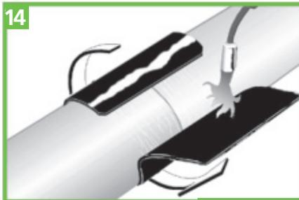
Das Superseal Produkt locker (**Durchhang ca. 10 % des Mantelrohrdurchmessers**) um das Muffen- und Mantelrohr legen. Die Trennfolie komplett entfernen und den Schmelzkleber am Ende der Schrumpfmanschette (Überlappung) kurz anwärmen. Die entsprechende Überlappung ohne Randversatz anlegen und den erwärmten Bereich mit dem Handballen fest andrücken.
