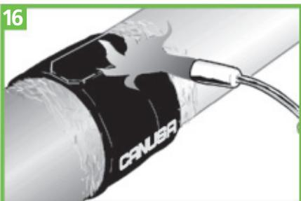
Mit einer weichen Propanflamme das separate Verschlussband abstreifen. Das Verschlussband mit dem Roller ganzflächig, senkrecht und möglichst fest auf die Schrumpfmanschette pressen. **Das Verschlussband muss am Ende ganzflächig mit der Schrumpfmanschette verbunden sein.** Ggf. die Kanten des CLRU-Verschlusses auch während des Schrumpfvorganges mit dem Roller andrücken.
