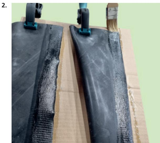
Die Klebeflächen (Breite jeweils ca. 30mm) werden mittels beiliegendem Kleber dünn eingestrichen. Der Kleber benötigt ca. 10 – 15 Min. Trocknungszeit.
