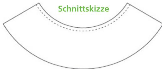
Wenn der Manschettendurchmesser für das Medienrohr zu klein ist, kann die AKG- bzw. AKO Manschette am Rand bauseits mit einer Schere oder Messer abgeschnitten werden (20 mm ergeben eine  $\varnothing$ -Vergrößerung von ca. 13 mm - 20 mm). Es ist darauf zu achten, dass die Manschette im Medienrohrbereich 2 – 5% kleiner ist, als der AD des Rohres, damit die Manschette faltenfrei anliegt.
