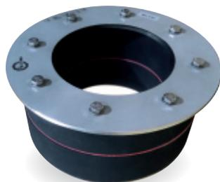
Die neue 4 pipes Fernwärme-Bodeneinführung zum **Einbetonieren in die Bodenplatte** für den Einzug und die sichere Abdichtung von **flexiblen Fernwärme-Leitungen**.
