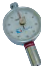
Shore D Messgerät
