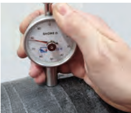
7. Kontrolle der Aushärtung nach ca. 60 Min. (ca. Shore D 70°±)
