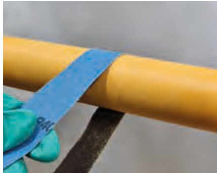
2. Oberfläche im Bereich der GFK Kufe aufrauen (Bsp.: Schmirgelleinen Körnung 40-60)
