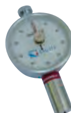
Shore D Messgerät
