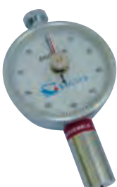
Shore D Messgerät
