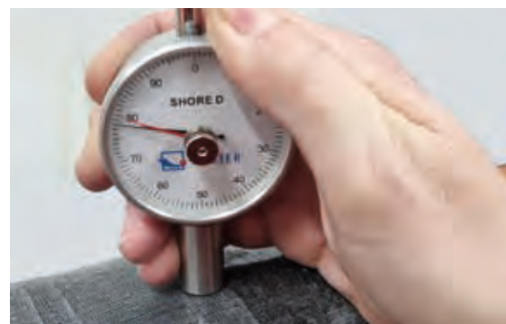
6. Kontrolle der Aushärtung nach ca. 60 min. (ca. Shore D 70°±)
